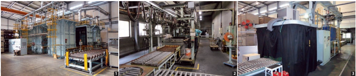
①バッチ式熱処理炉（自動プログラムによりT4・T6等の処理が可能です） ②酸アルカリ洗浄装置（連続自動処理でアルミ等がもつ本来の清浄な表面に仕上げます） ③蛍光探傷装置（非破壊検査により表面欠陥等の流出を防止します）
